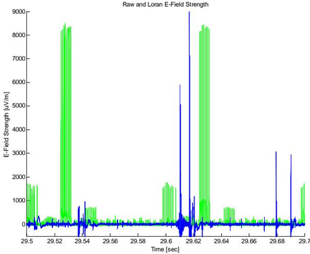
Fig. 3. Superposition of actual lightning data and Loran pulses.
