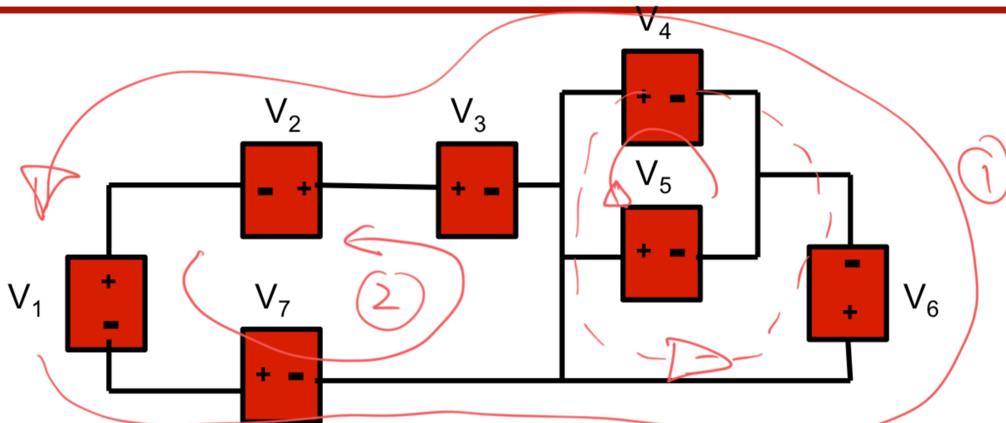
$$\textcircled{1} \quad V_1 + V_2 - V_3 - V_4 + V_6 + V_7 = 0$$
