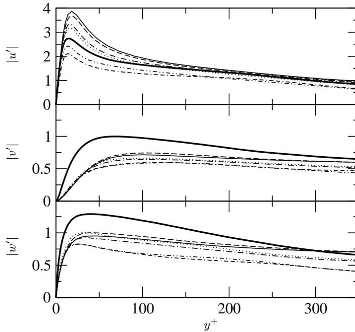
FIGURE 4. Velocity fluctuations in the streamwise  $|u'|$ , wall-normal  $|v'|$ , and spanwise  $|w'|$  directions. — : DNS, - - : DSM (64,49,48), - - - : DSM (128,97,96), - · - : DMM (64,49,48), ····· : DMM (128,97,96), - · · - : DRM (64,49,48), and · - - · : DRM (128,97,96).
