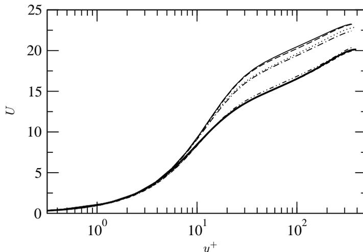
FIGURE 3. Mean velocity profiles using different turbulence closure models. — : DNS, — : DSM (64,49,48), - - - : DSM (128,97,96), — · — : DMM (64,49,48), ····· : DMM (128,97,96), — · · — : DRM (64,49,48), and — · — · : DRM (128,97,96).
